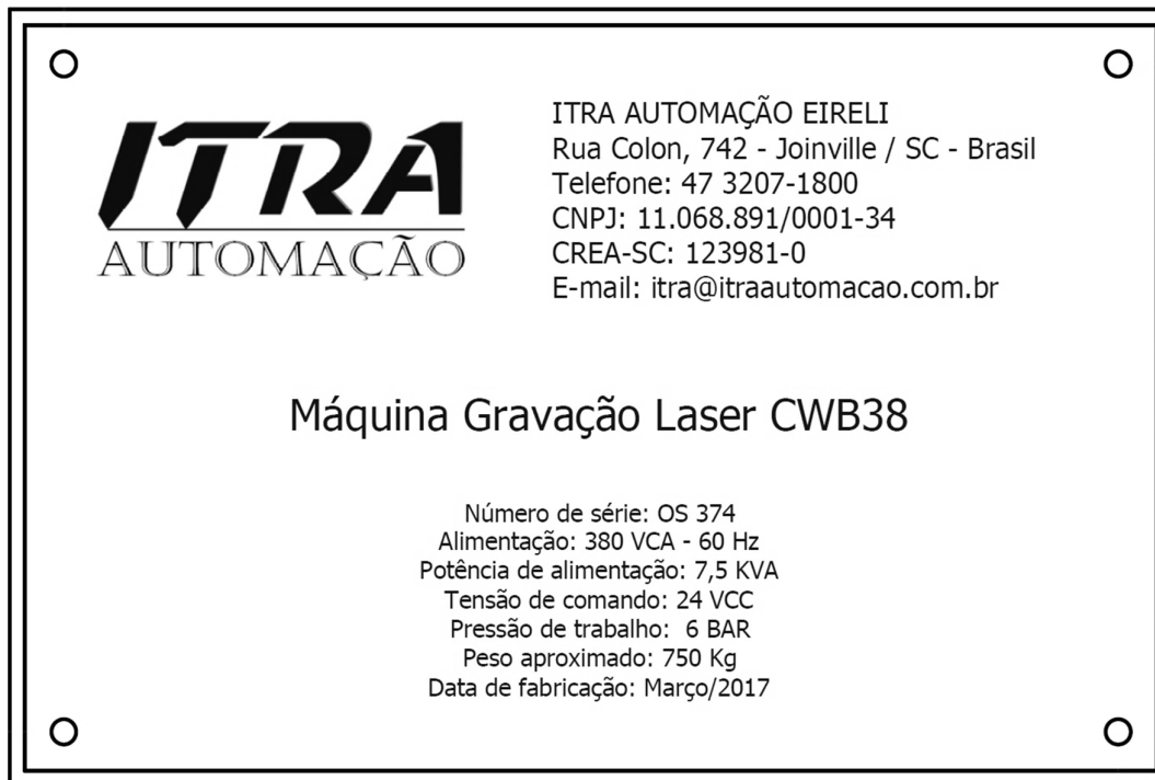
Figura 2 – Placa de identificação
