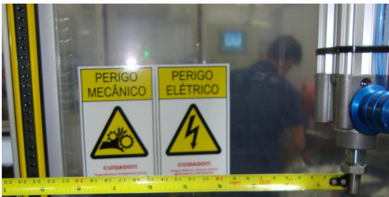
Figura 38 – Distância Cortina de Luz Cilindro Superior (230mm)
