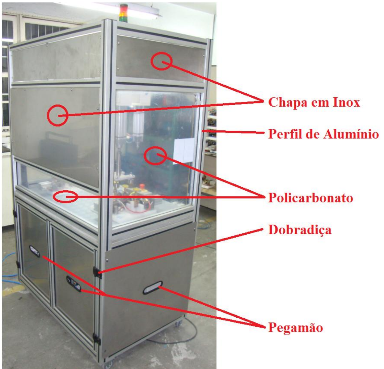
Figura 18 – Apontamento das Proteções Fixas, e Moveis Sem Monitoramento
